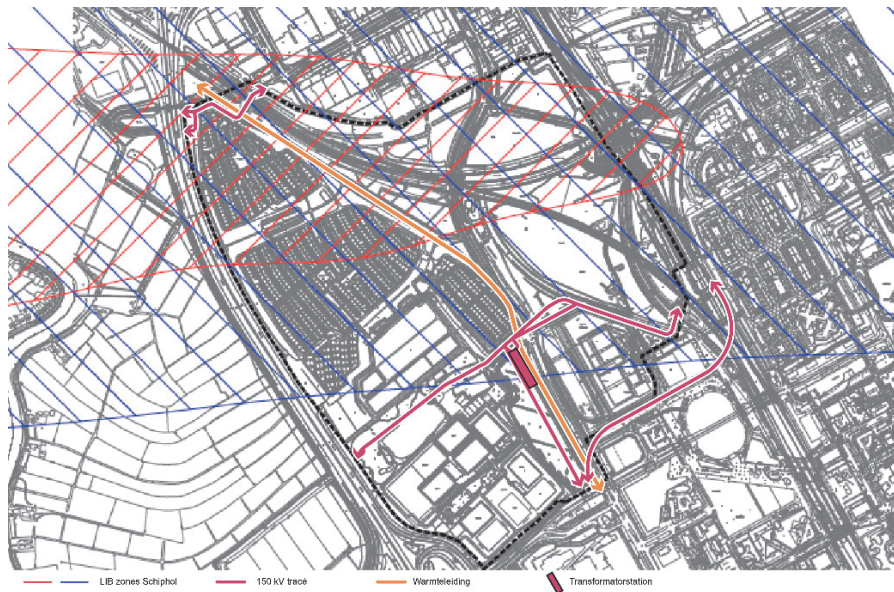
Ligging LIB-zones, 150 kV tracé, transformatorstation en warmteleiding
